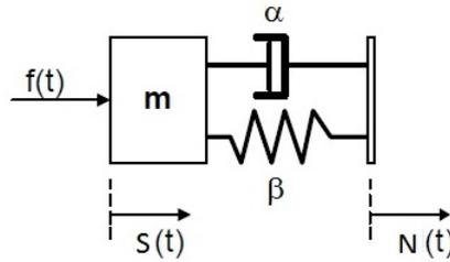
L'objectif du problème de contrôle est de générer une force externe, qui pourrait compenser le bruit de déplacement  $N$ . Cette force externe générée est ajustée par le contrôleur et est notée  $f$ . Par conséquent, nous avons deux signaux d'entrée  $N$  et  $f$  (les contrôles) et un signal de sortie  $S$ . Partant de l'état initial  $S_0$ , le système dynamique satisfait par  $S$  est donné par l'équation d'état suivante:
